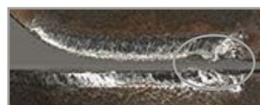
Filo de corte dañado
